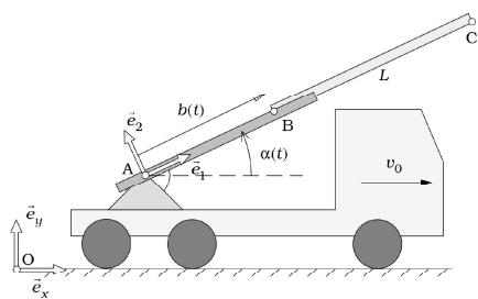
Bestimmen Sie die Absolutgeschwindigkeit sowie die Absolutbeschleunigung des Punktes C sowohl aus der Sicht einer mitfahrenden Person, d.h. im mitbewegten Koordinatensystem  $e_1, e_2$  als auch aus der Sicht eines außenstehenden Beobachters, d.h. im raumfesten Koordinatensystem  $e_x, e_y$ .
