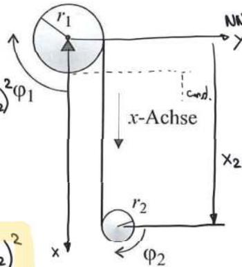
ZB:  $x_2 = (\text{const.} +) r_1 \varphi_1 + r_2 \varphi_2$
